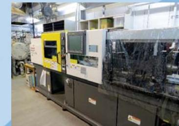
複雑形状の粉末部品を作製可能な粉末射出成形(MIM)技術。写真は50t射出成型機。
