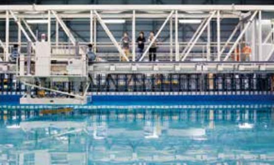
船舶運動性能試験水槽(長さ38.8m×幅24.4m)
