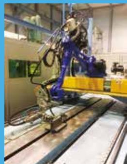
レーザ・アークハイブリッド溶接実験装置
