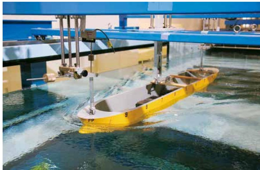
高速回流水槽を使った船体抵抗試験
