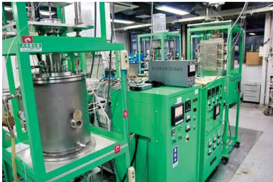
1600°Cの高温酸化物および金属融体の物理化学的性質の評価装置群
