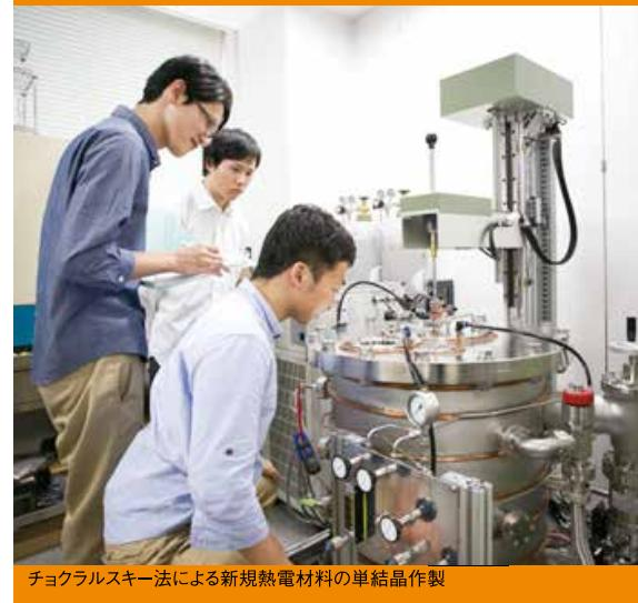
チョクラルスキ法による新規熱電材料の単結晶作製
