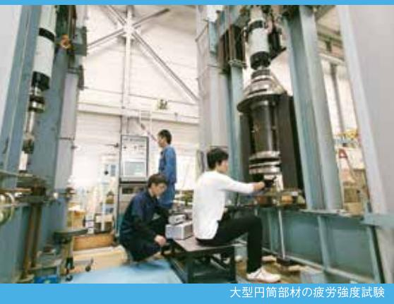
大型円筒部材の疲労強度試験
