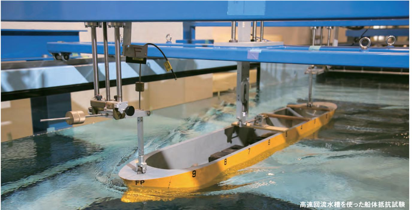
高速回流水槽を使った船体抵抗試験
