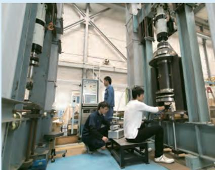
大型円筒部材の疲労強度試験
