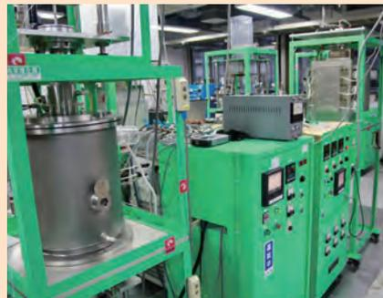
1600℃の高温酸化物および金属融体の物理化学的性質の評価装置群
