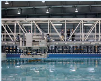
船舶運動性能試験水槽
