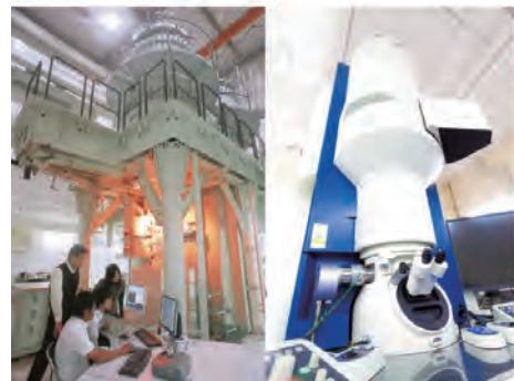
超高圧電子顕微鏡と世界最高水準の計測感度をもった分析電子顕微鏡
