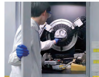
X線回折装置を用いたセラミックスの結晶構造解析
