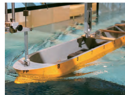
高速回流水槽を使った船体抵抗試験
