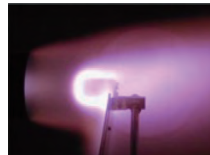
アーケ加熱風洞による耐熱試験
