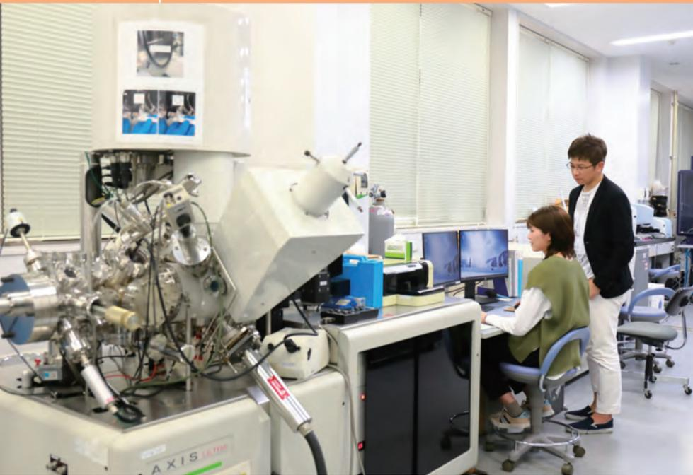
X線光電子分光装置を使った電子状態解析
